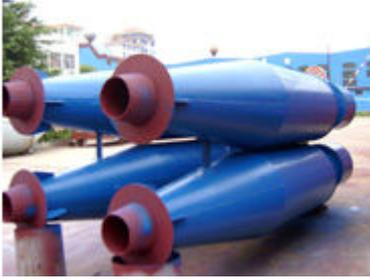
• CLK 扩散式旋风除尘器,适用于捕集干燥的非纤维性的颗粒状粉尘,主要特点是
