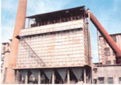
• MDC 防爆型袋收尘器采用防静电滤料,机体具有防爆结构,并设有泄压装置,具
