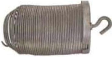
• 弹簧骨架具有一定的伸缩性，因除尘器受室内空间的限制，除尘器的顶部没有一定的空间来更换除尘骨架。0317-8348461
